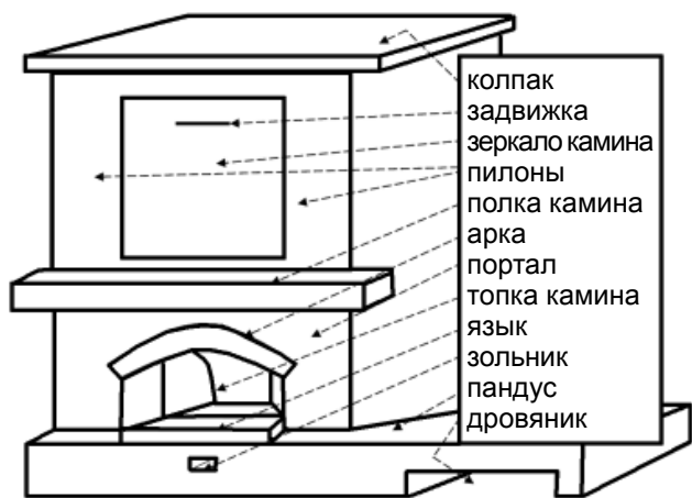
Внутреннее устройство камина
